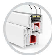
T-Energy 6 komór głębokość ramy 88 mm
